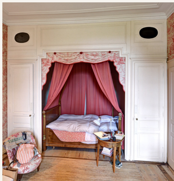
Une chambre à coucher dans l'aile ouest. La bouche de pulsion d'air chaud a pris place dans l'un des œils-de-bœuf des boiseries d'alcôve.
