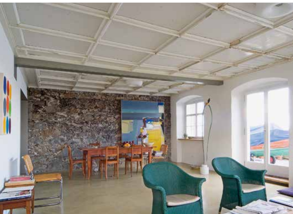
Une des fenêtres a été agrandie pour créer une sortie sur le jardin. A cet endroit, il faut tenir compte des crues; le sol a été reconstruit en conséquence, il a été isolé et on y a coulé une dalle de béton.
