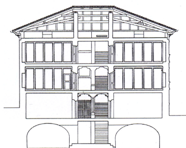
Sezione trasversale con un appartamento a sinistra e l'altro a destra
